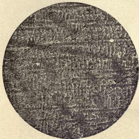
Fig. 19. \times 150 Alloy 12. Cu 78.2 chill cast. Sn 15.5 \alpha + \gamma . Zn 6.3.
